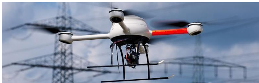
Рисунок 1. Обстеження ЛЕП з використанням квадрокоптера
