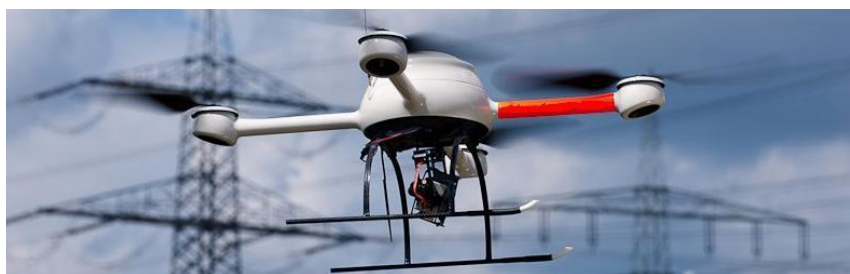
Рисунок 1. Обстеження ЛЕП з використанням квадрокоптера
